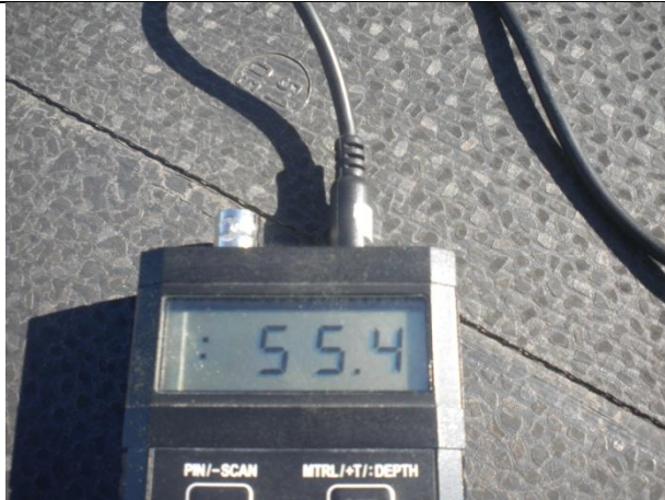
En måling af den relative luftfugtighed inde i elementet gav en lav værdi.
