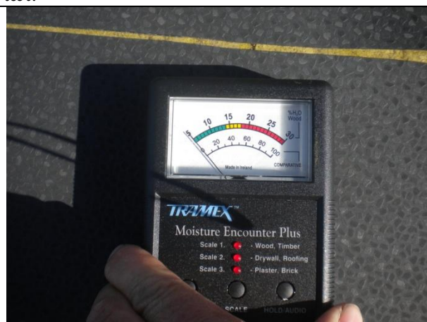
Der kunne heller ikke måles fugt i denne del af taget.
